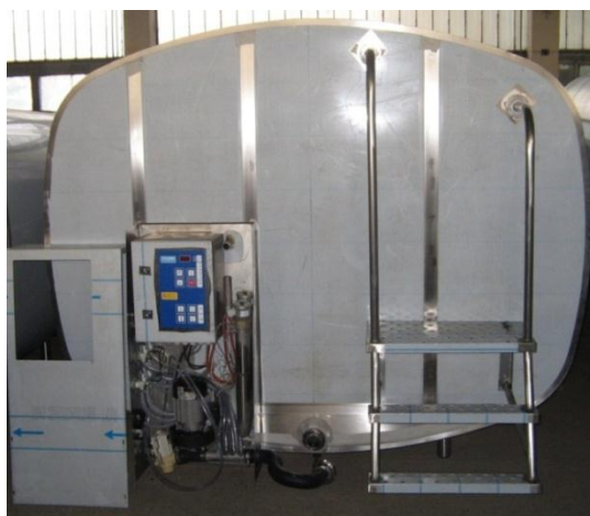
Рисунок 1. – Охладитель молока ОМР-8 для роботизированной технологии доения (вид спереди)
