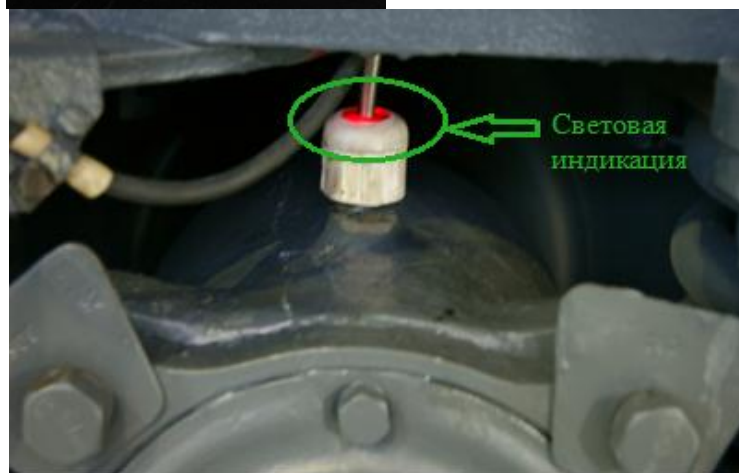
Рисунок 5. – Световая индикация датчика ДТРПН непрерывного (5а) и прерывистого (5б) свечения на перегретой буксе
