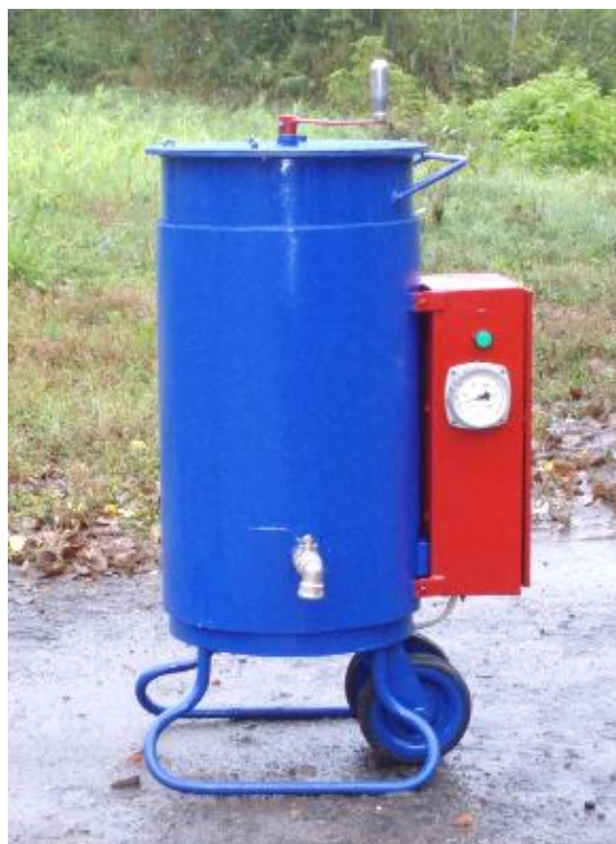
Рисунок 1. – Установка ОПУ-80 для приготовления загущенной смазки
