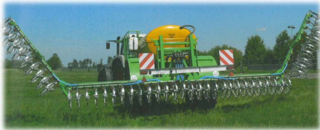
Рисунок 4. – Машина фирмы VMR Veenhuis с инжекторным адаптером
