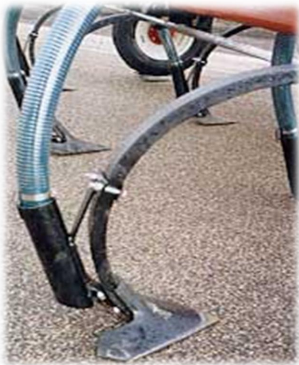
Рисунок 9. – Стрельчатая лапа на чизельной стойке
