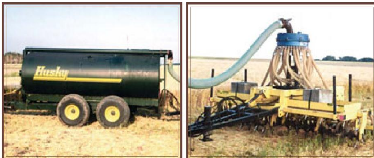
Рисунок 5. – Машина фирмы Husky с клиновидным рабочим органом
