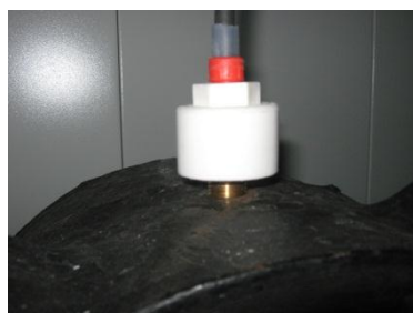
Рисунок 4. – Датчик-реле ДТРПН для контроля работы шарикоподшипников с установкой под ключ
