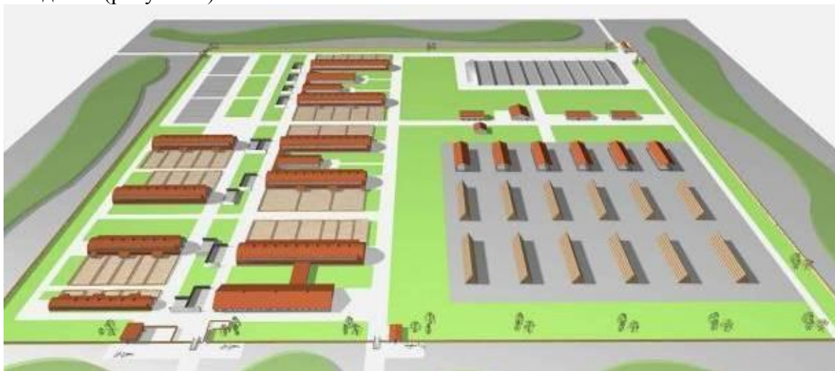
Рисунок 2. – Ферма по производству молока на 920 коров беспривязного содержания на глубокой несменяемой подстилке с выращиванием ремонтного молодняка
