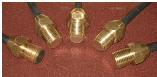
Рисунок 2. – Датчики-реле с температурами срабатывания 75 °С и 94 °С
