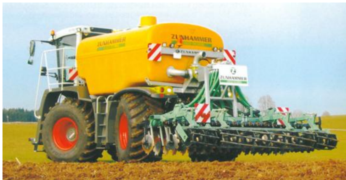
Рисунок 3. – Машина фирмы Zunhammer с дисковым адаптером
