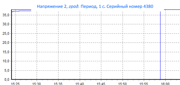
Рисунок 9. – Временная зависимость тока в цепи датчика с пороговой температурой 94 \pm 4 °C при изменении его температуры
