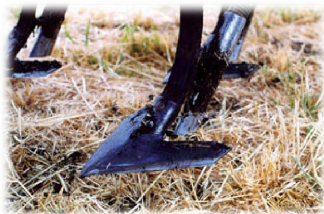
Рисунок 7. – Стрельчатая лапа на жесткой стойке
