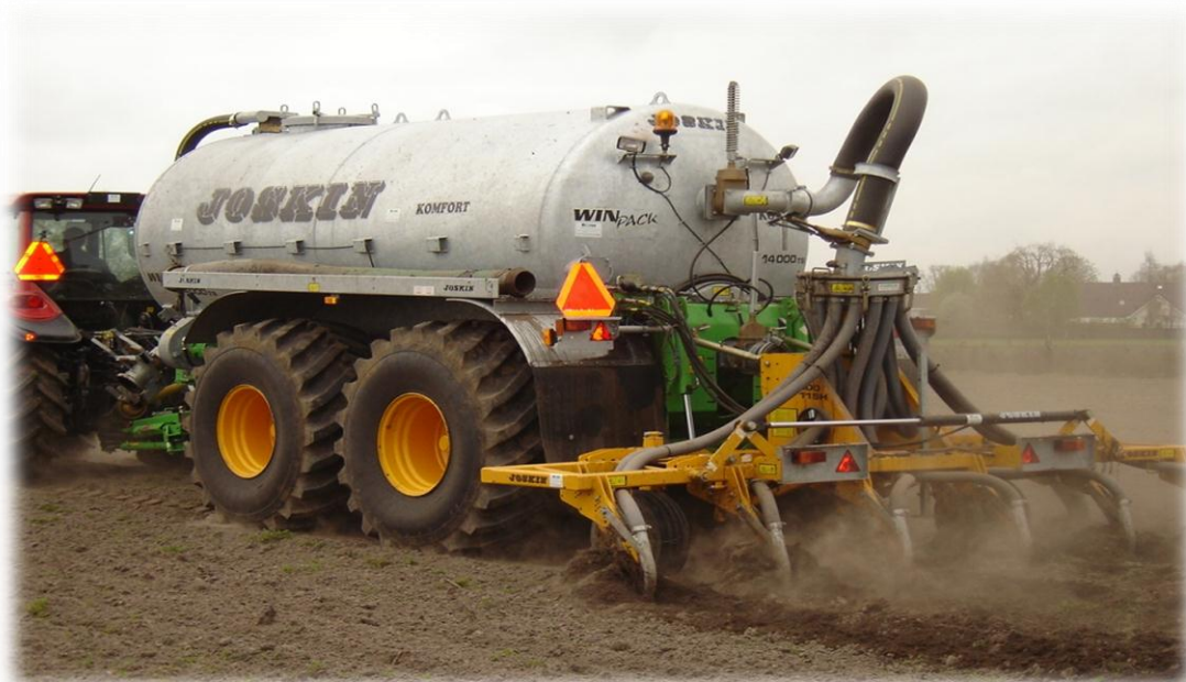
Рисунок 2. – Машина фирмы Joskin с чизельным адаптером
