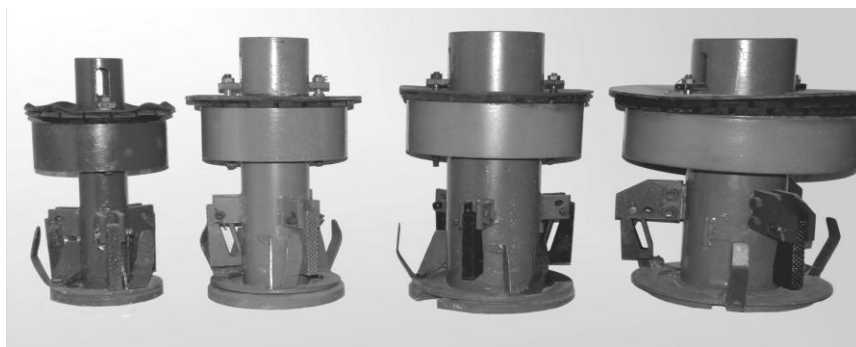
Рисунок 2. – Устройство для откачки воды по обсадной колонне скважины диаметрами 219, 273, 324, 377, 426 мм
