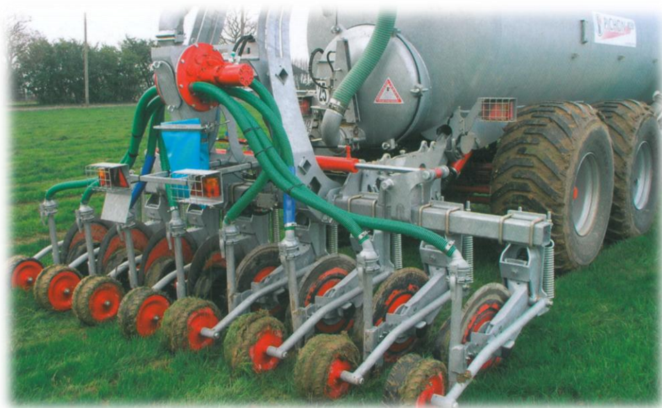
Рисунок 1. – Машина фирмы Pichon с плоским дисковым адаптером
