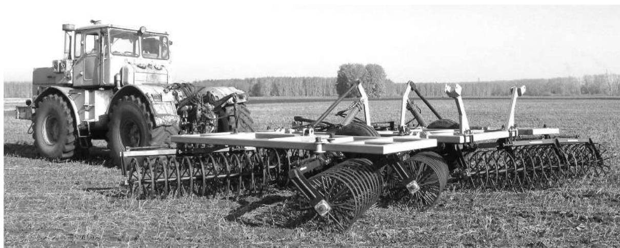
Рис. 3. Бороны кольцевые секционные «Лидер-БКС-8»
