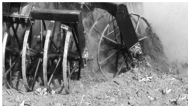
Рис. 2. Перемещение почвы кольцами катка у кольцевой бороны, передний каток установлен с углом атаки влево, задний вправо
