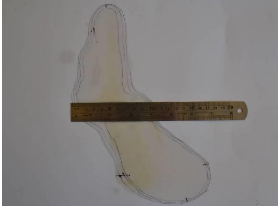
Рисунок 10 – Фрагмент измерения размера пятна в горизонтальном направлении линейкой (ТСМ – свежее моторное масло)
