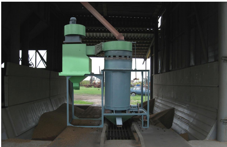
Рисунок 4.16 – Воздушный центробежно-решетный сепаратор на испытаниях
