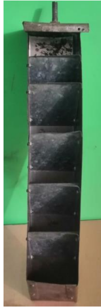
Рисунок 3.9 – Экспериментальная установка отбора проходовой фракции по высоте цилиндрического решета с пластинчатым барабаном
