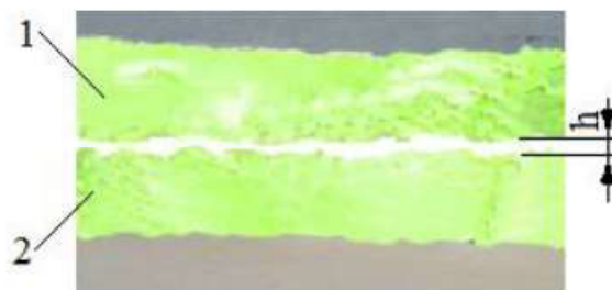
1 – игла распылителя форсунки; 2 – седло корпуса распылителя форсунки.
