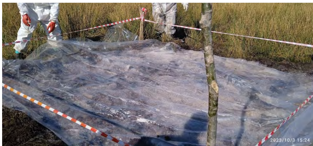
Рисунок 82 – Опытный участок, накрытый полиэтиленовой пленкой
