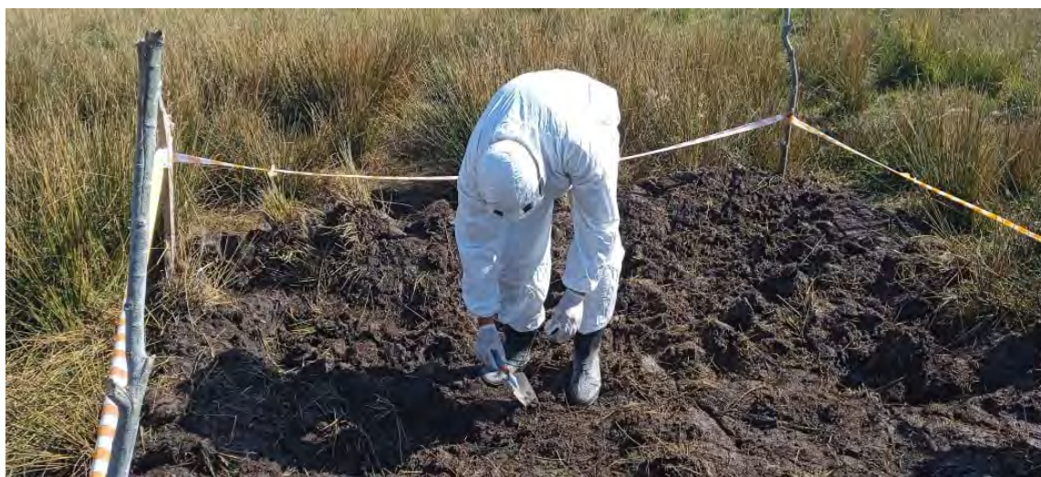
Рисунок 83 – Процесс отбора проб на экспериментальном участке после снятия верхнего слоя почвы через 48 часов
