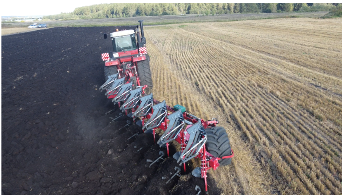
Рис. 5. Работа пахотного агрегата в положении «в борозде»
