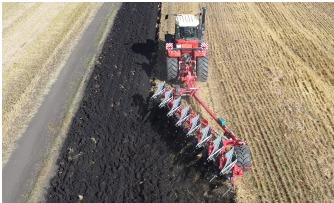
Рис. 4. Работа пахотного агрегата в положении «вне борозды»
