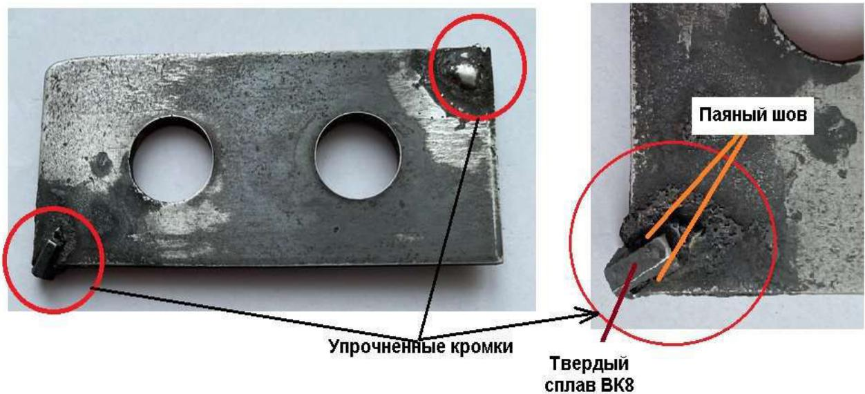
Рисунок 4.1 – Образец молотка с упрочненной рабочей кромкой
