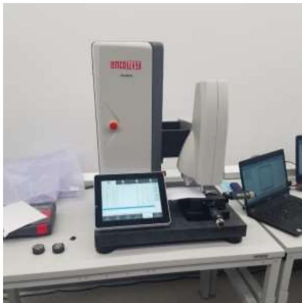
Рисунок 3.6 – Определение микротвердости твердомером DuraScan
