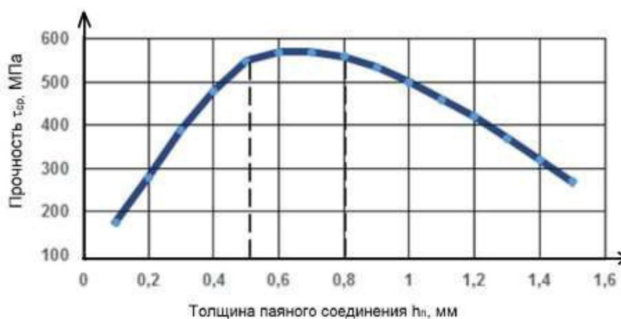
Рисунок 4.14 – Зависимости прочности соединения от толщины паяного шва
