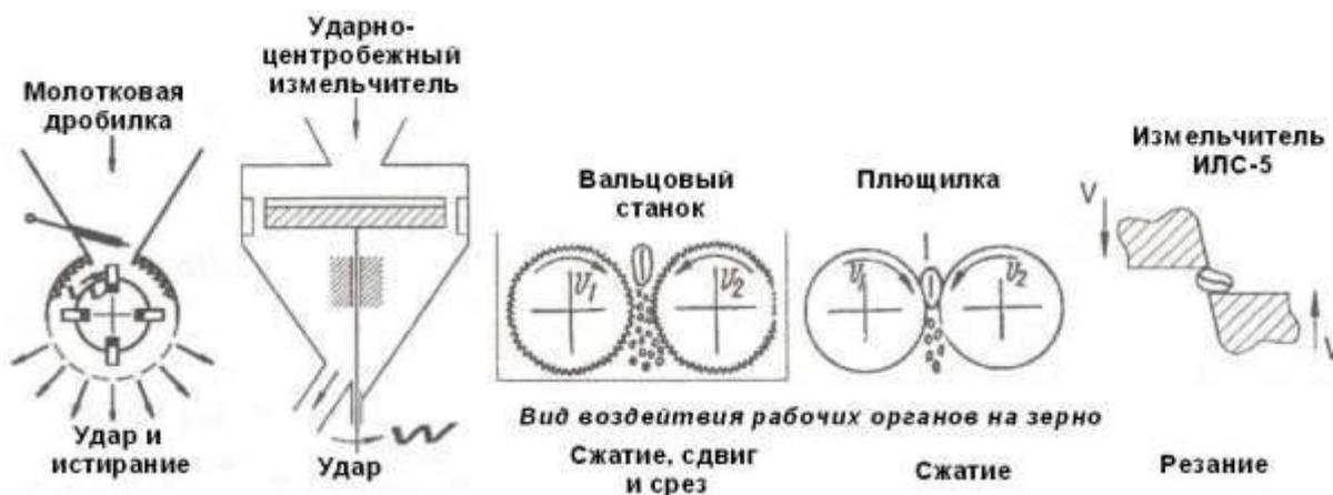
Рисунок 1.1. – Рабочие органы, применяемые для измельчения зерна
