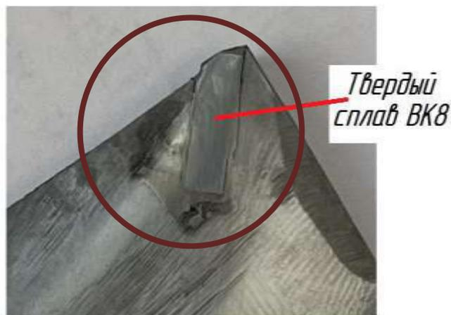
Рисунок 4.2 – Микрошлиф упрочненной кромки молотка
