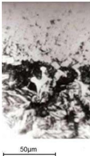
Рисунок 4.7 – Микроструктура зоны растворно-диффузионного взаимодействия
