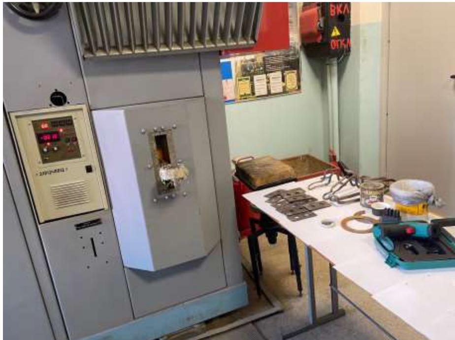
Рисунок 3.1 – Оборудование для пайки упрочненных молотков
