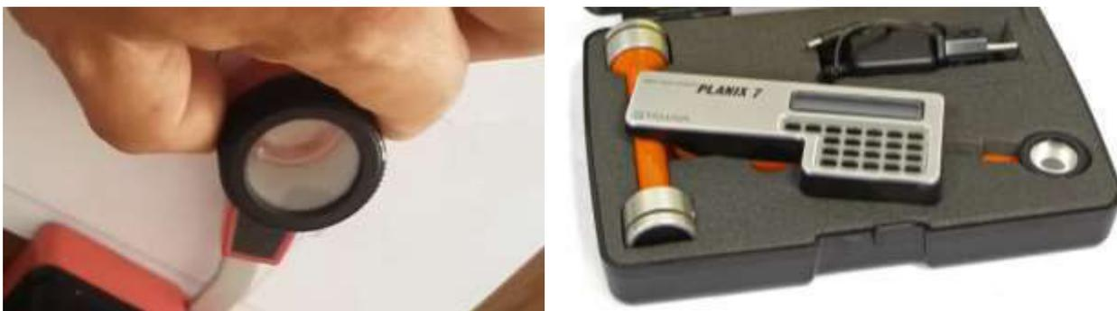
Рисунок 3.8 – Прибор для определения площади износа по профильным кривым износа молотков
