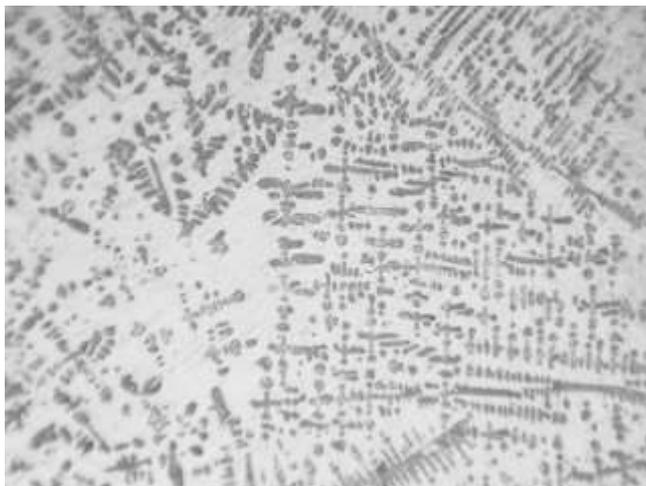
Рисунок 2.7. – Микроструктура FeC-припоя ( $\times 250$ )
