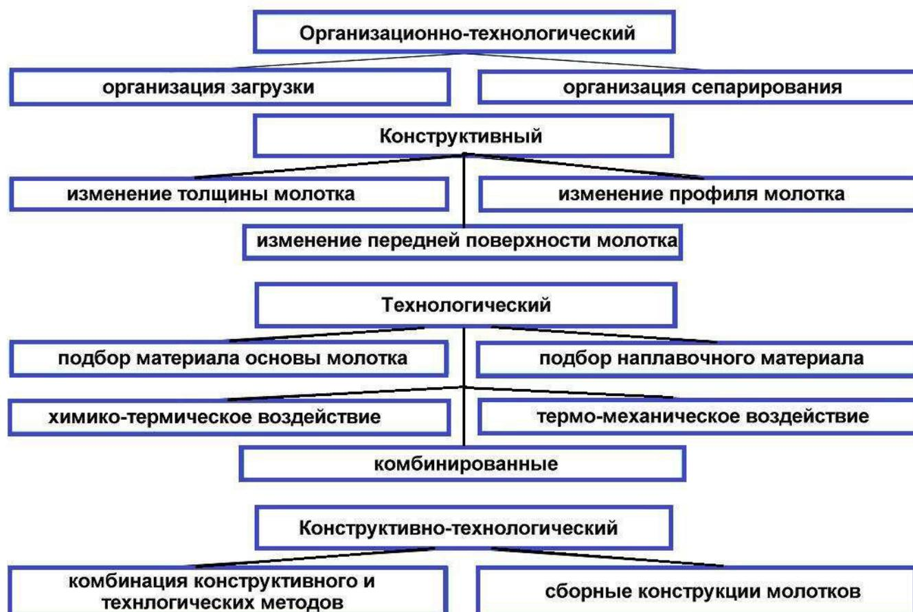
Рисунок 1.6 – Методы повышения эксплуатационного ресурса молотков зернодробилок
