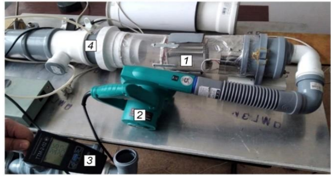
Рисунок 5 – Установка № 3 для определения рациональных режимов работы генератора НТП: 1- генератор НТП, 2- вентилятор, 3- термоанемометр, 4- точка пробоотбора
