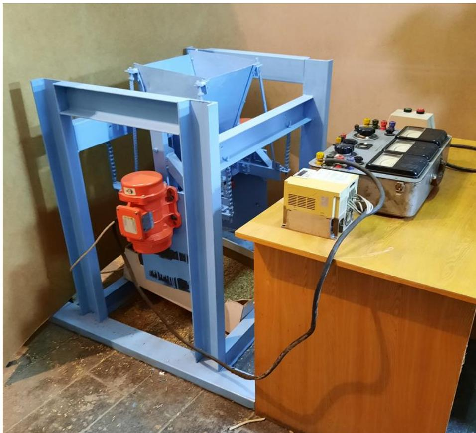
Рисунок 4.10 - Общий вид экспериментального вибрационного измельчителя
