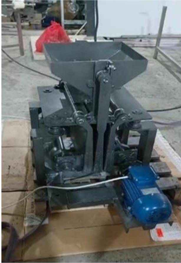
Рисунок 6.1 - Вибрационный измельчитель кормового зерна
