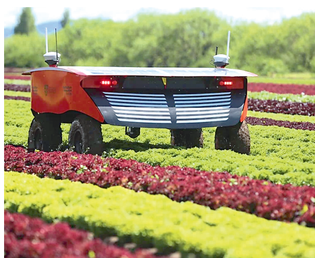
Рис. 2. Автономный робот Rippa, оснащенный интеллектуальным аппликатором для быстрой обработки растений и аэрозольного внесения нанудобрений (внекорневая подкормка) [13]
