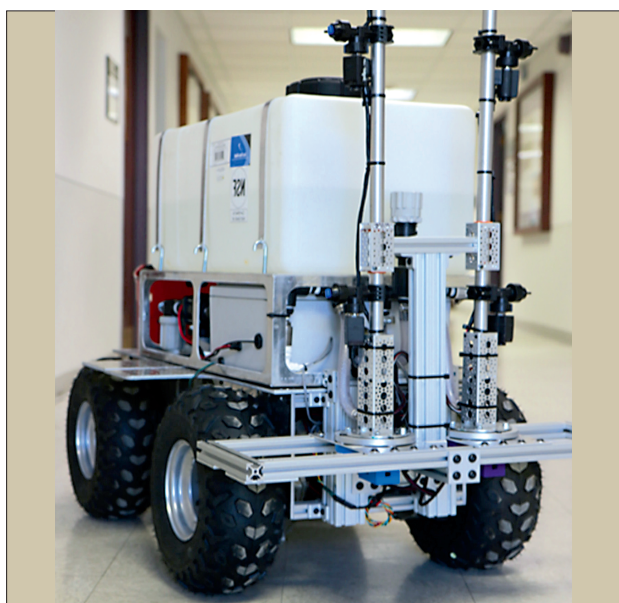
Рис. 1. Общая конструкция робота-опрыскивателя с форсунками, ориентированными для распыления перпендикулярно ряду растений [14]
