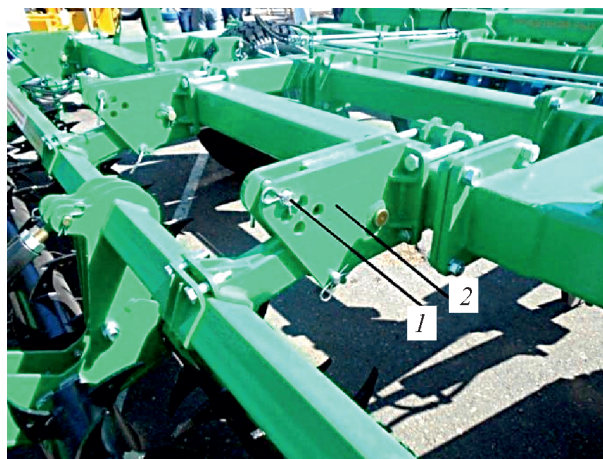
Рис. 3. Регулировка глубины обработки почвы на кронштейне катка:
