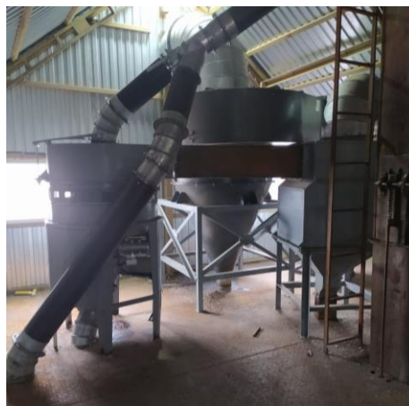
Рисунок 44 – Производственная проверка центробежно-воздушного сепаратора в СПК «Дружба» Алейского района Алтайского края (июнь 2023 года)
