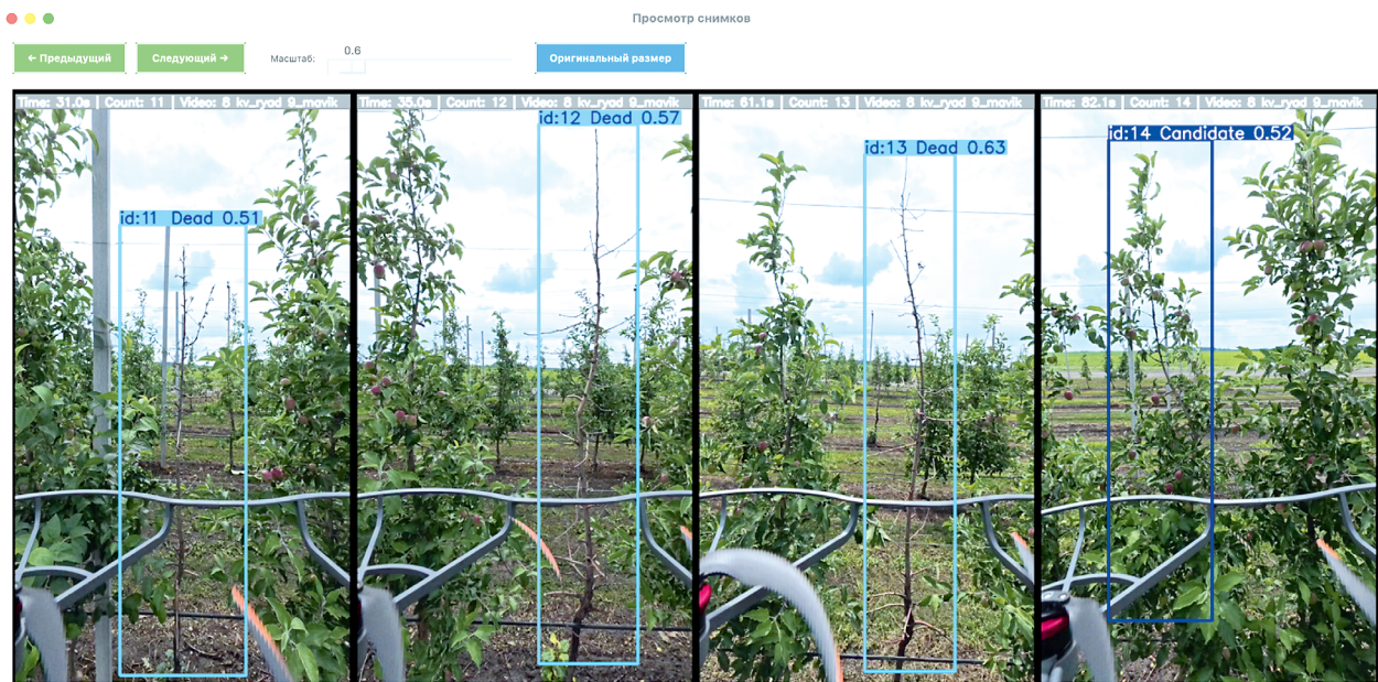
Рис. 7. Пример работы программы: результаты распознавания выпадов в рядах садовых насаждений Fig. 7. Example of program operation: results of recognition of plant extinction in the rows of orchard plantings
