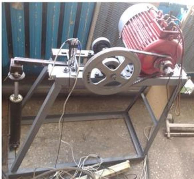
Рисунок 3.2 – Экспериментальная установка №2 Стенд для определения эксплуатационных характеристик амортизаторов
