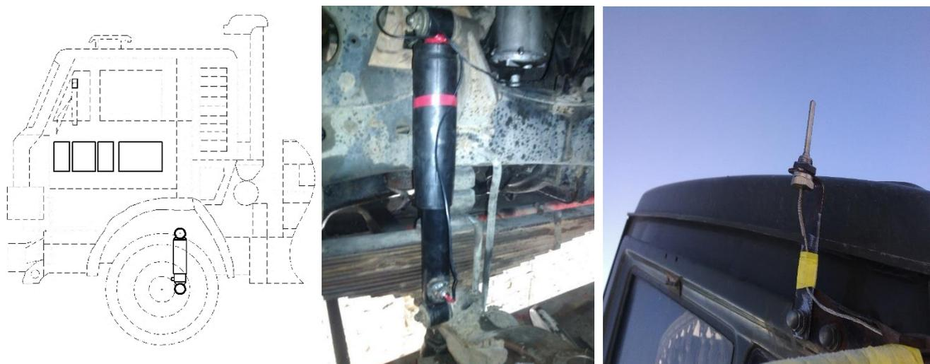
Рисунок 3.1 – Экспериментальная установка №1 на базе автомобиля КамАЗ 5320 с установленными датчиками контроля температуры амортизаторной жидкости и температуры окружающей среды
