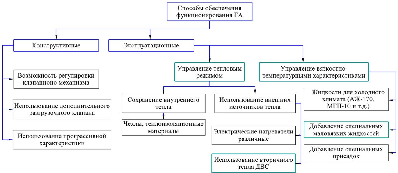
Рисунок 1.10 – Способы обеспечения функционирования гидравлических амортизаторов автомобиля
