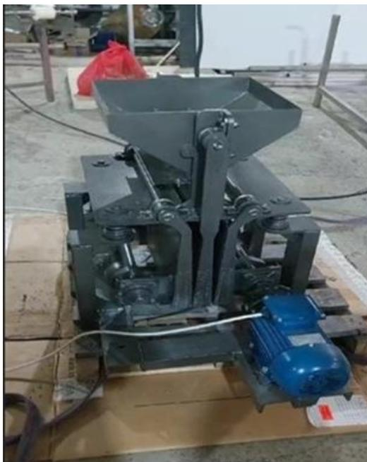
Рисунок 22 - Вибрационный измельчитель кормового зерна производительностью 300 кг/час (разработка ООО "Глобал Инжиниринг", г. Барнаул)
