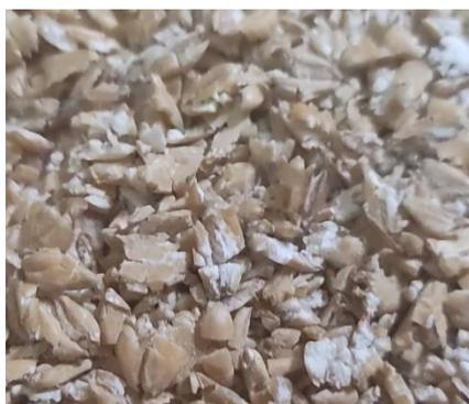
Рисунок 16 - Вид разрушенных вибрацией зерновок
