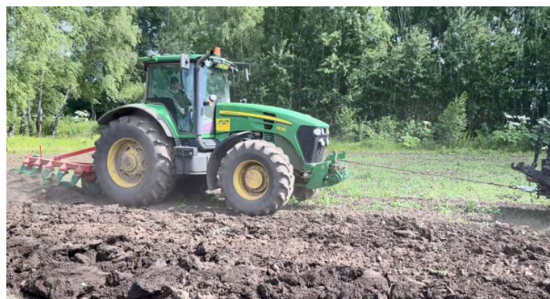
Рис. 13. Исследования по определению энергетических показателей (тягового усилия)
