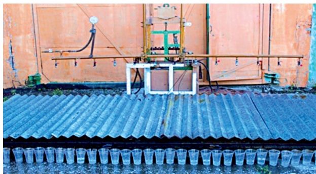
Рис. 1. Лабораторная установка для оценки качества распределения распыленной рабочей жидкости
