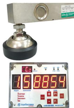
Рисунок 3.10. – Устройства дозирования и определения влажности: а) дозирующего устройства электронного типа ДУЭТ; б) Замер влажности зерна на Wile 65.
