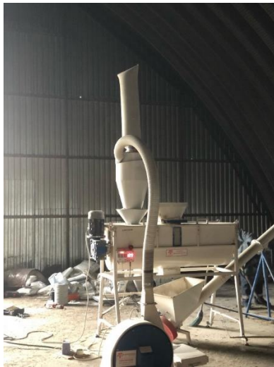
Рисунок 3.13. – Установленный фильтр мешок на двухступенчатый циклон и на БЦР-450 (Слева на право соответственно).
