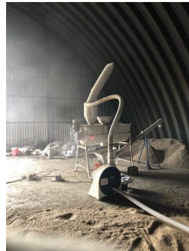
Рисунок 3.13. – Установленный фильтр мешок на двухступенчатый циклон и на БЦР-450 (Слева на право соответственно).
