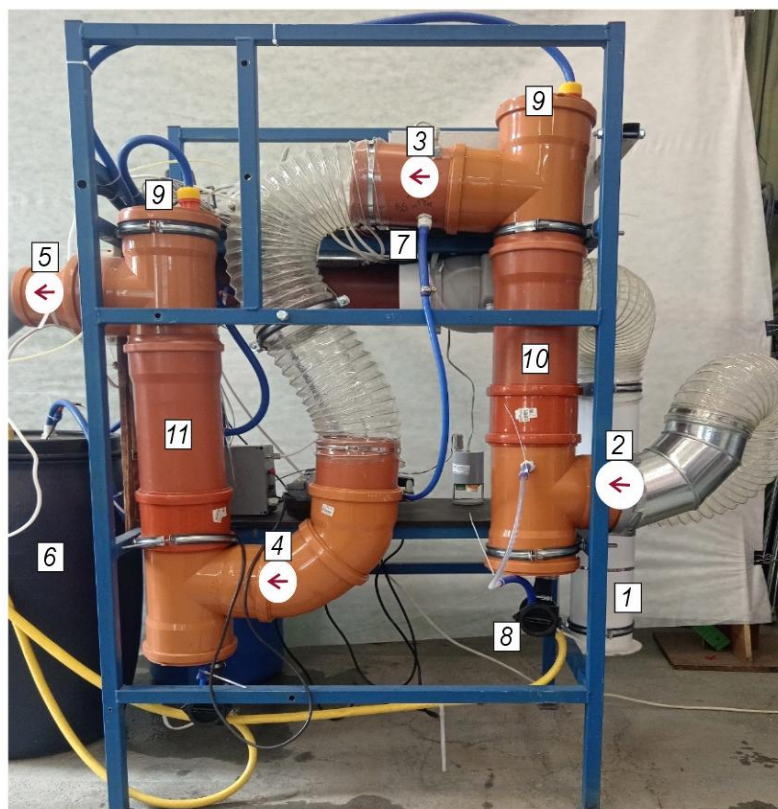
Рисунок 3.5 – Экспериментальная установка №1: 1–генератор аммиака, 2-5– точки отбора проб, 6– циркуляционный резервуар, 7– ввод НТП, 8– откачивающая помпа, 9– форсунки дождевателя, 10, 11– скрубберы
